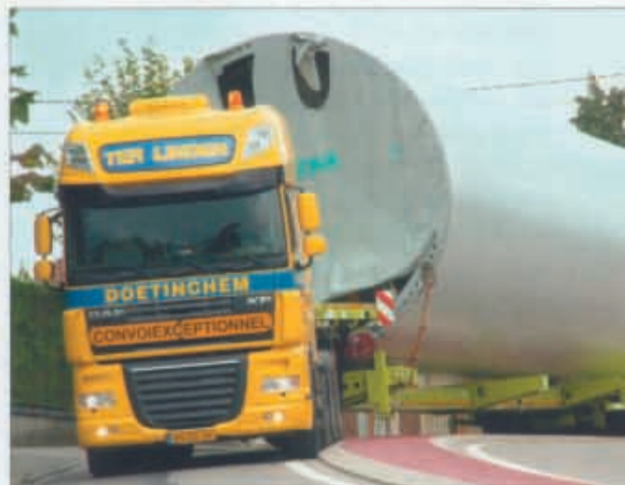
5,10 Meter Höhe und 4,20 Meter Breite ergeben einen eindrucksvollen Transport.
