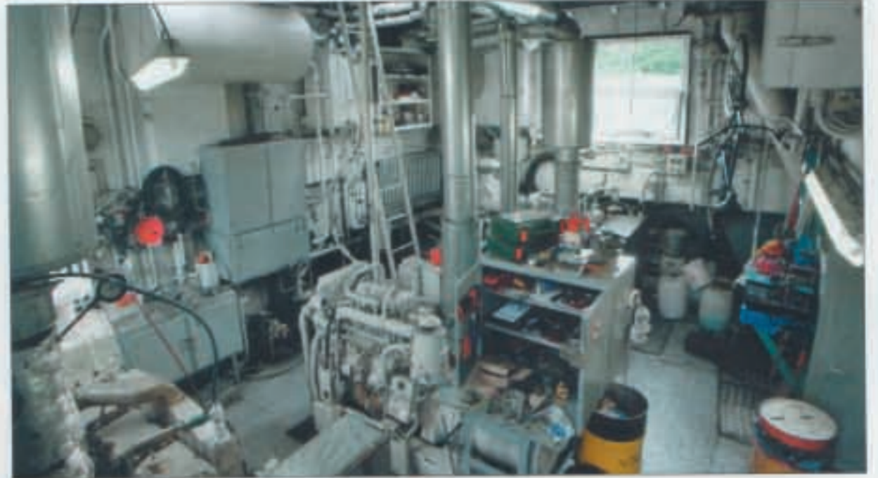
Zwei Reihensechszylinder von Cummins leisten 500 PS.
